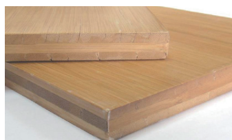
竹材对剖联丝重组材料
